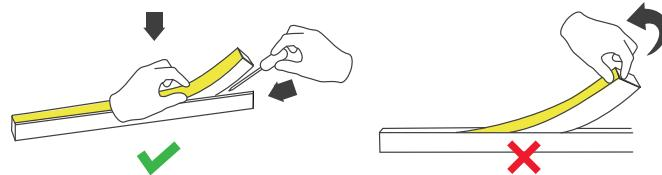
Для демонтажа ленты используйте инструмент [отвертку с плоским лезвием].
