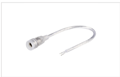
Артикул 022354 Круглый герметичный разъем DC 2-pin МАМА для соединения отрезков одноцветных светодиодных лент. Корпус IP65. Провод 20AWG 15 см. Максимальный допустимый ток 3А.
